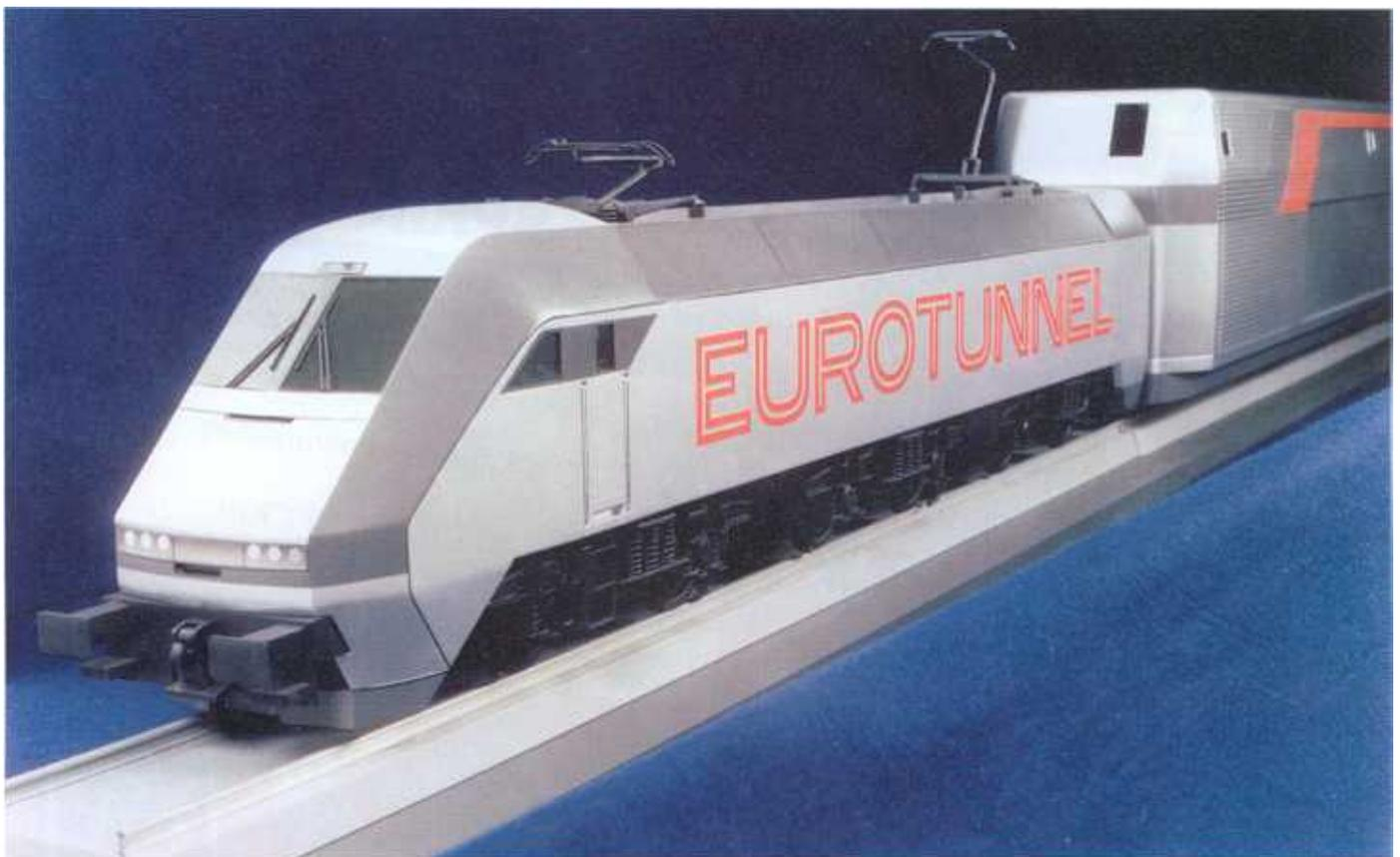
Fig. 1. - Maquette des navettes ferroviaires permettant le transport des véhicules routiers. (Photo QA.)
