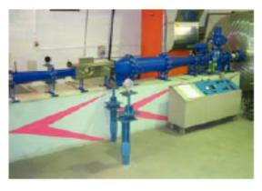
Veine de mesure de 0.12 × 0.08 [m<sup>2</sup>] vitesse de 3000 [km/h]
