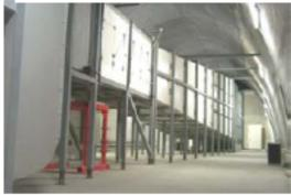
2 veines de mesure :  $2.0 \times 1.5 \text{ [m}^2$ ] vitesse de 280 [km/h]  $3.4 \times 3.4 \text{ [m}^2$ ] vitesse de 150 [km/h]
