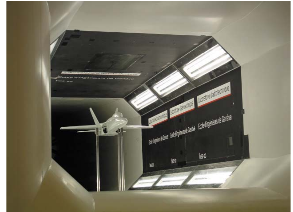
Montage d'un modèle sur pilônes motorisés
