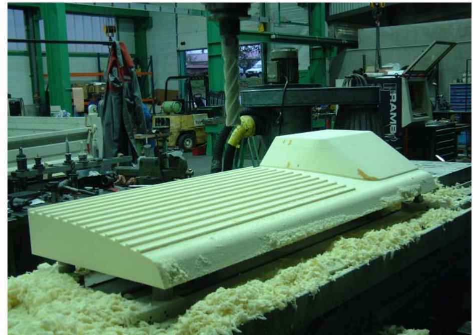
Usinage d'une des maquettes à l'aide d'une machine-outil cinq axes
