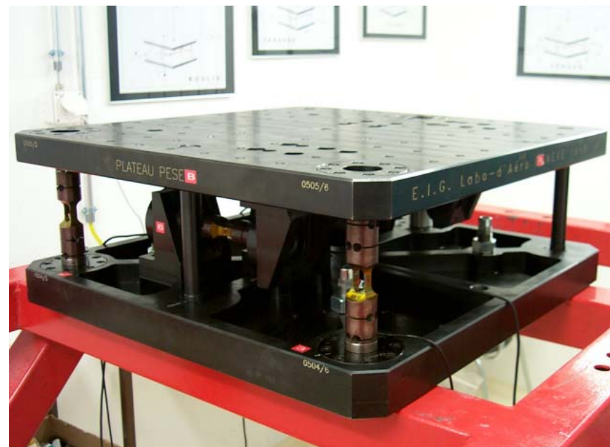
Balance à six composantes à jauges d'extensométrie
