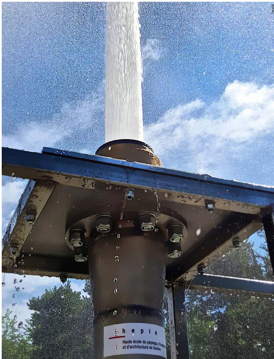
Banc d'essais réalisé par hepia pour le développement d'une buse de jet d'eau économe en énergie. Ce projet a été développé par les étudiants d'hepia : Ali Abbassi, Andrea Cominetti et Théodore Grinling. Dans l'idée de résister davantage aux vents, une buse à géométrie variable a été développée. Elle permet d'adapter le débit du jet aux conditions météorologiques. D'où l'importance de l'aérodynamisme.
