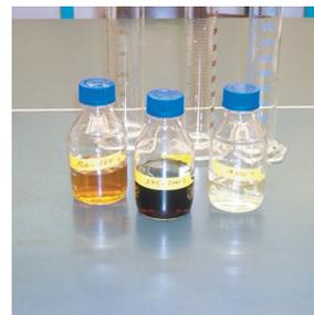
Das Biobenzin wird aus einem aus organischen Abfällen hergestellten Bio-Erdöl gewonnen. Im Gegensatz zu seinen Konkurrenten liefert das Biobenzin dieselben Leistungen wie Benzin aus Erdöl, erfordert keine Änderung des Motors und weist eine sehr günstige Grauenergiebilanz auf.
