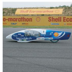
Um das Biobenzin zu fördern und seine Verwendung in einem handelsüblichen Motor zu validieren, haben wir ein äusserst energiesparsames Fahrzeug konzipiert und realisiert. Dabei wurde der Minimierung von Reibungen, mechanischen wie aerodynamischen, besondere Aufmerksamkeit geschenkt.
