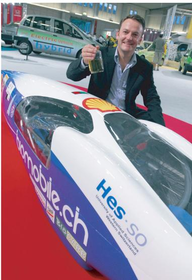
Um die Universalität des Biobenzins zu beweisen, haben wir ein Fahrzeug realisiert, das von einem handelsüblichen Motor angetrieben wird, der jedoch in jeder Hinsicht optimiert wurde, um den Verbrauch zu reduzieren. Dieses Fahrzeug nimmt regelmässig am Shell Eco-Marathon teil, wo er 840 km mit einem Liter Biobenzin bewältigt hat.
